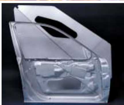
Soldeo de Tailored Blank en la fabricación de puertas para vehículos
