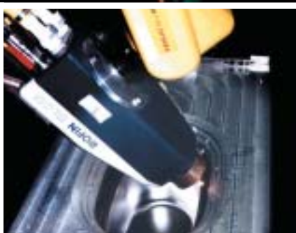
Soldeo con láser de diodo
